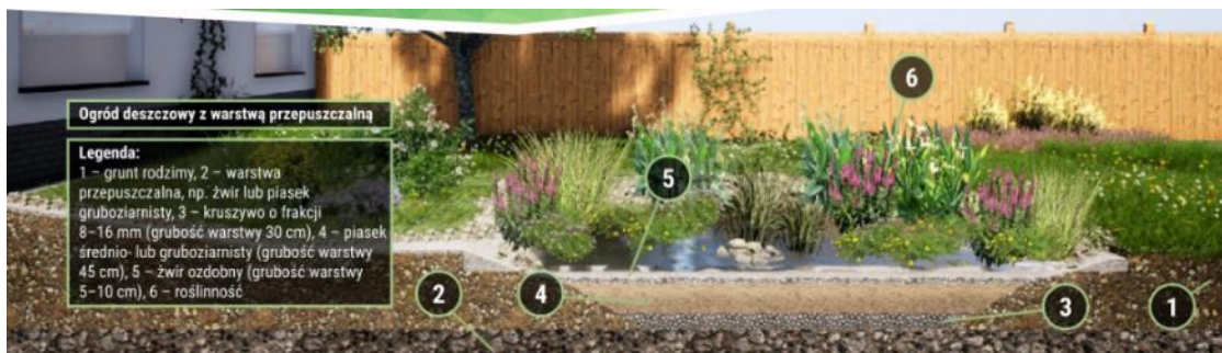
Rysunek 20. Przekroje przez typowe ogrody deszczowe w gruncie (źródło: Katalogi dobrych praktyk z Wrocławia i Bydgoszczy)
