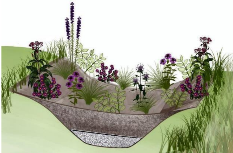
Rysunek 21. Typowy przekrój przez muldę chłonną
