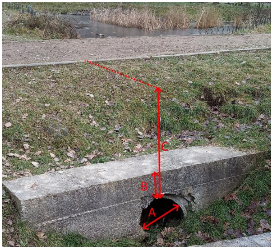
Rysunek 5. Sposób pomiaru przepustów (źródło: własne)
