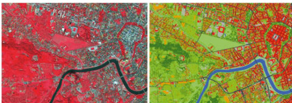
Ryc. 5.5. Przykład mapy pokrycia i użytkowania terenu (po prawej) opracowanej na drodze analizy obrazu GEOBIA obrazów wielospektralnych VHR WorldView-2 (Maxar; po lewej; kompozycja CIR)
