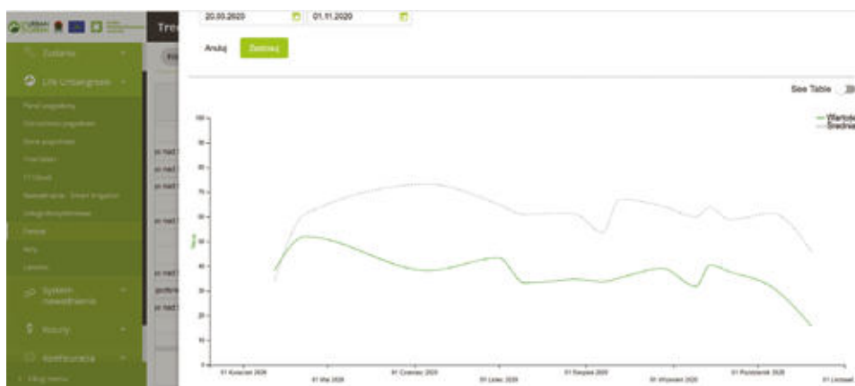
Ryc. 6.6. Dynamika wskaźnika Treesat w okresie kwiecień – październik 2020 r. dla korony klonu zwyczajnego ArboTag nr 092343 (linia ciągła) i wartości średnie dla wszystkich badanych drzew tego gatunku (linia przerywana). Wizualizacja dostępna w zakładce Treesat (moduł Life Urban-green) w aplikacji GreenSpaces
