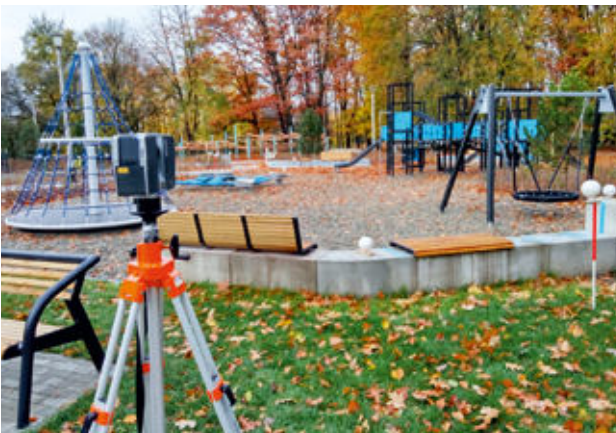
Ryc. 2.7. Pozyskiwanie chmur punktów 3D z wykorzystaniem technologii naziemnego skanowania laserowego (TLS LiDAR) na placu zabaw w Parku Lotników Polskich
