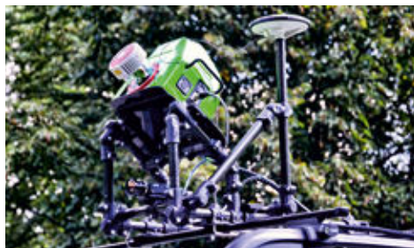
Ryc. 2.3. Platforma ROBIN (3D Laser Mapping) wykorzystana do mobilnego skanowania laserowego (MLS)
