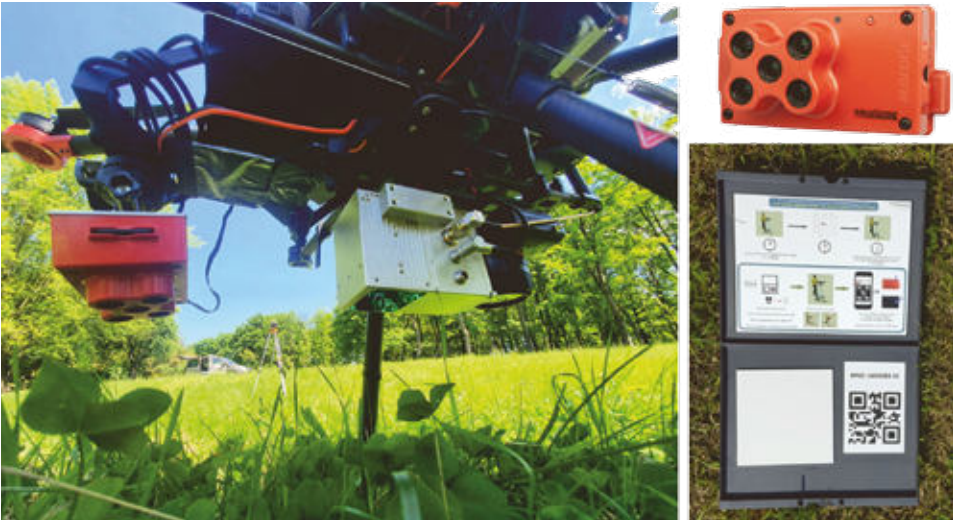
Ryc. 6.1. Kamera RedEdge-M (MicaSense), skaner laserowy GS-260P (Geosun Navigation) z kamerą Sony RXII (42 Mpx) na platformie BSP DJI Matrice 600 Pro oraz panel kalibracyjny MicaSense
