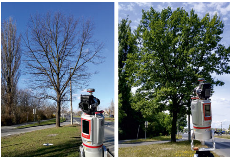
Ryc. 7.1. Skanowanie TLS dębu szypułkowego Quercus robur (ArboTag nr 008348) rosnącego przy al. Pokoju w Krakowie. Skanowanie w stanie bezliściowym (z lewej) oraz w pełni ulistnionym (z prawej)
