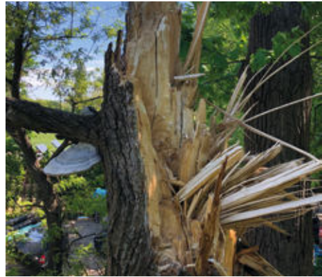
Ryc. 12.4. Efekt zmian struktury i właściwości drewna spowodowany rozkładem typu białego – pień topoli czarnej Populus nigra o obwodzie ponad 300 cm (Park Lotników Polskich, ArboTag nr 036875) złamał się na wysokości ok. 8–10 m w miejscu, gdzie rozwijał się hubiak pospolity Fomes fomentarius (owocnik widoczny na zdjęciu)
