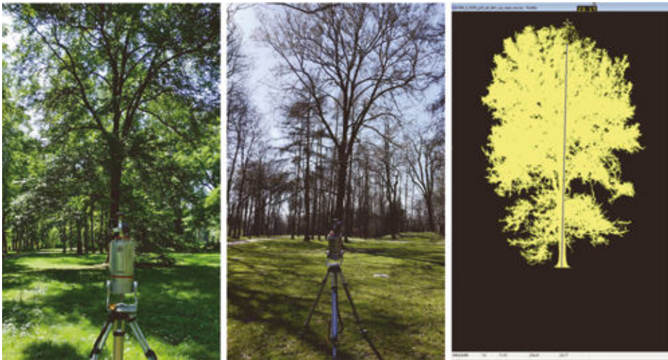
Ryc. 7.2. Wiąz szypułkowy Ulmus leavis (ArboTag nr 008299) skanowany w stanie ulistnionym (po lewej) oraz bezlistnym (w środku). Połączona chmura punktów TLS dla stanu bezlistnego (po prawej)
