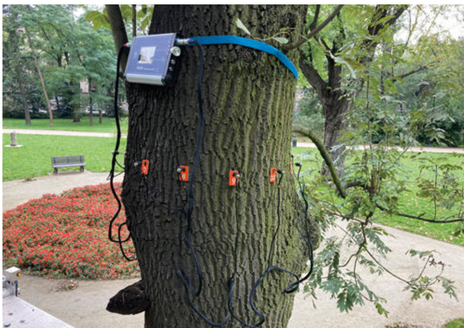
Ryc. 12.6. Jesion wyniosły Fraxinus excelsior poddany badaniu tomografem dźwiękowym PiCUS 3 z powodu widocznego na wys. około 3–4 m owocnika grzyba patogenicznego – błyskoporka szczytkowatego Inonotus hispidus (Park Krakowski, ArboTag nr 038524)
